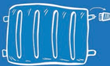
3 Развийте старите механични вентили от радиаторите - ръчно или с помощта на подходящ инструмент (например гаечен ключ, клещи и др.). Не е нужно източване на водата от радиатора, няма да потече.
