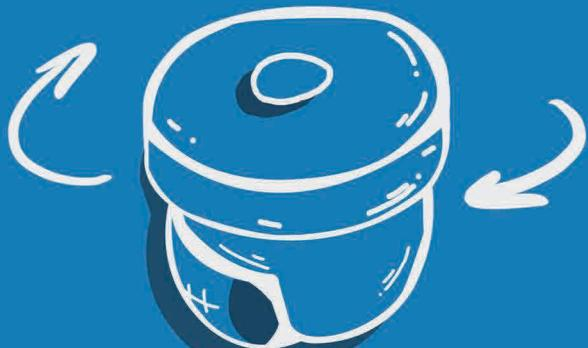
7. Прикрепете безжичния сензор за движение Zip the Fish™ към монтираната на стената стойка. За целта първо наклонете сензора под ъгъл надолу, така че изпъкната част на капака да може да влезе в отвора отпред на стойката. След това натиснете сензора нагоре за да се закрепи към стойката (ще чуете изщракване).
